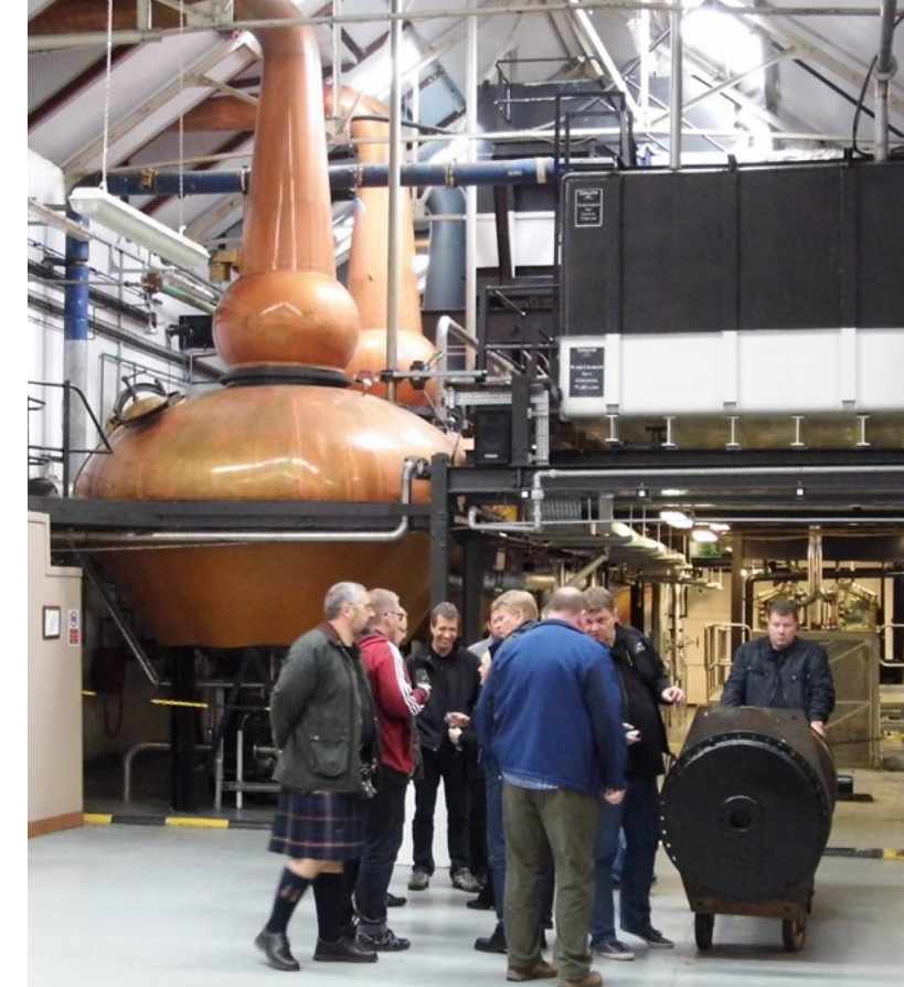
Brennblasen hat Tomatin 12 Stück, aber nicht alle sind in Betrieb. Immerhin fast 3 Millionen Liter Alkohol werden im Jahr hergestellt.
